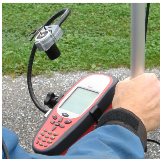
Die Schwanenhalskamera registriert die Manipulationen am GPS-Gerät.
